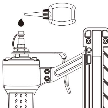
3. Después de agregar el aceite, haga funcionar la herramienta por un breve periodo. Limpie el exceso de aceite de la salida de la cubierta.
