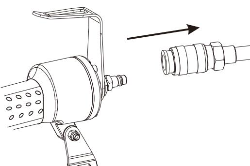
2. Gire la herramienta de forma tal que la entrada de aire dé hacia arriba. Coloque 2 a 3 gotas de aceite neumático de la herramienta de la cerradura en la entrada de aire. No utilices aceite detergente ni aditivos puesto que estos Lubricantes causarán el desgaste acelerado de los sellos y amortiguadores de la herramienta, lo que resultará en el mal funcionamiento de la misma y elevará la frecuencia del mantenimiento.
