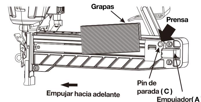
**ADVERTENCIA:** La herramienta puede dispararse al ser conectada por primera vez a la fuente de aire. Conecta siempre la herramienta a la fuente de aire antes de cargar los fijadores para evitar lesiones causadas por ciclos accidentales. Asegúrate siempre de que el cargador de la herramienta esté vacío al comienzo de cada sesión de trabajo, antes de conectarla a una fuente de aire.
