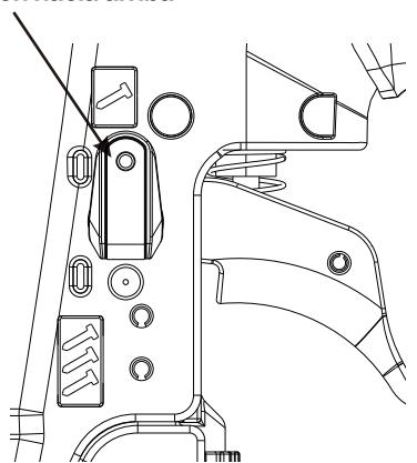
Nota: Primero tirar del gatillo, entonces presione el elemento de contacto de trabajo contra la superficie de trabajo, la clavadora NO PUEDA funcionar.
