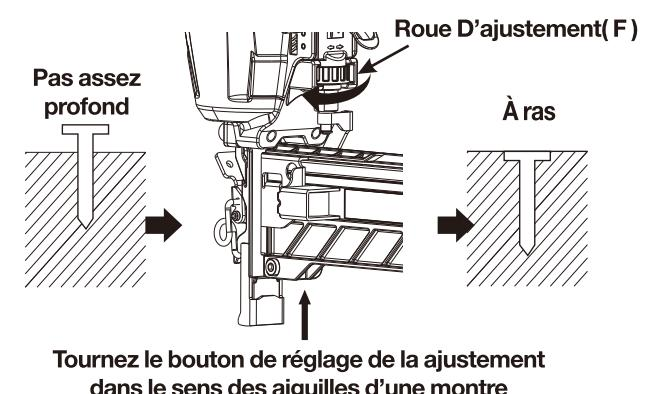
**ATTENTION:** Il est recommandé de tester la profondeur de clouage sur une pièce inutilisée afin de déterminer la profondeur requise pour l'application.
